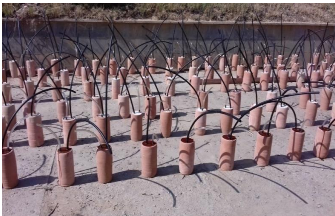
استفاده از رزین در بخش فوقانی سفال ها برای آبیندی و استحکام
