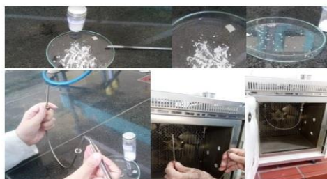
روش تهیه اجزای ستون (کوی و لایه نشانی با MOF) و نصب آن در دستگاه کروماتوگرافی گازی
