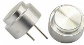
شکل ۴- نمونه پراب ۱ گیرنده و فرستنده فراصوت
